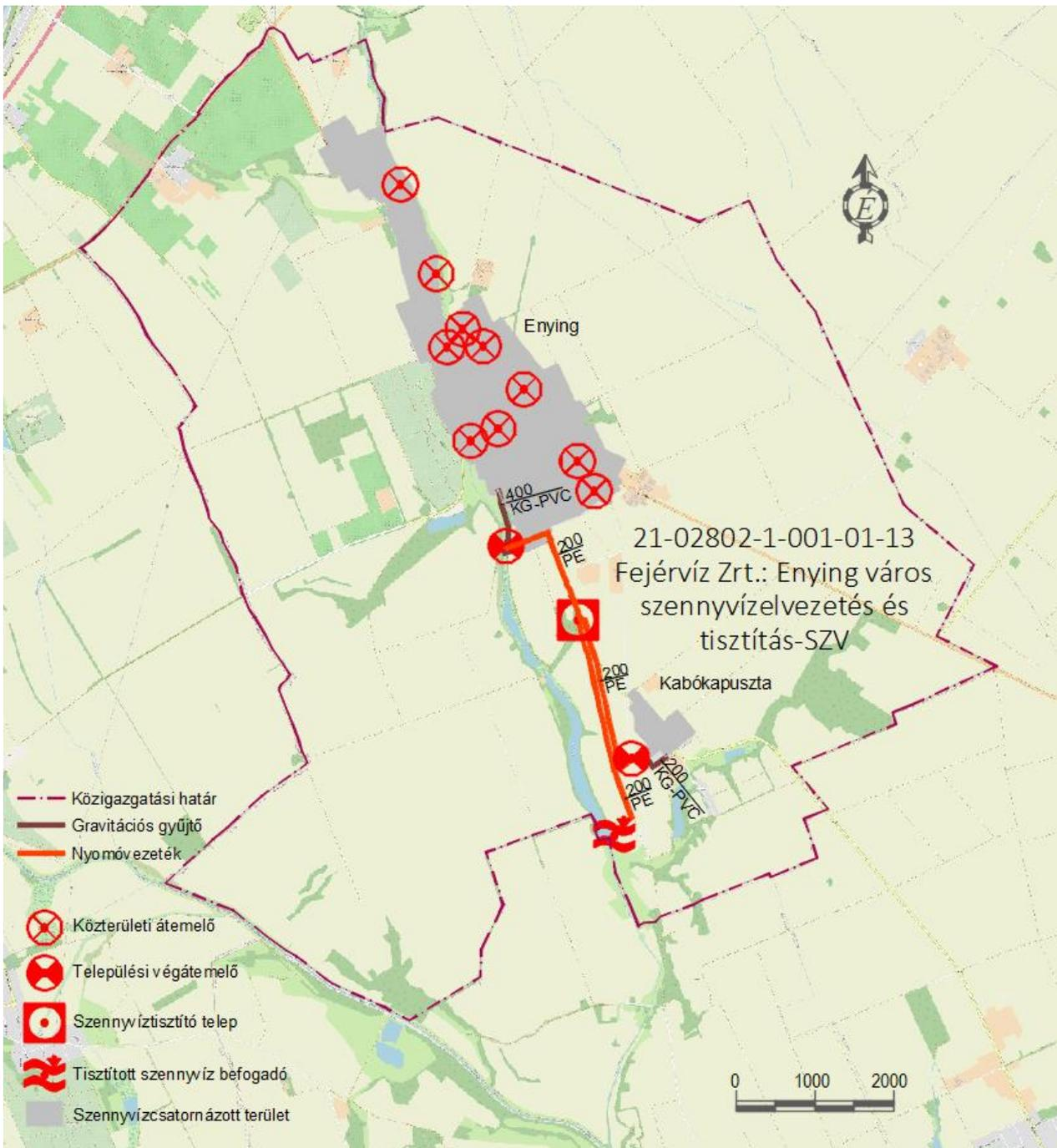
4. ábra Enying településen üzemelő szennyvízelvezető és -tisztító víziközmű-rendszer áttekintő helyszínrajza
